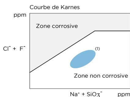
Remarque : les analyses chimiques des ions réalisées conformément aux normes ASTM C-795 et C-871 montrent que les produits en laine de roche ISOVER ne génèrent pas la corrosion de l'acier car la relation des ions Cl<sup>-</sup> + F<sup>-</sup> par rapport aux ions Na<sup>+</sup> + SiO<sub>3</sub><sup>-</sup> se situe dans la partie inférieure de la Courbe de Karnes.
