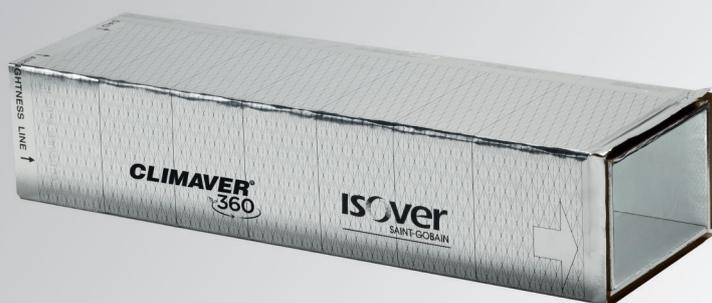
Panneau rigide en laine de verre **ISOVER** à haute densité, revêtu à l'extérieur d'une feuille d'aluminium mate renforcée de papier kraft et d'un filet de verre, qui fait office de pare-vapeur, et à l'intérieur d'un nouveau tissu noir en filet de verre renforcé à haute résistance mécanique.
