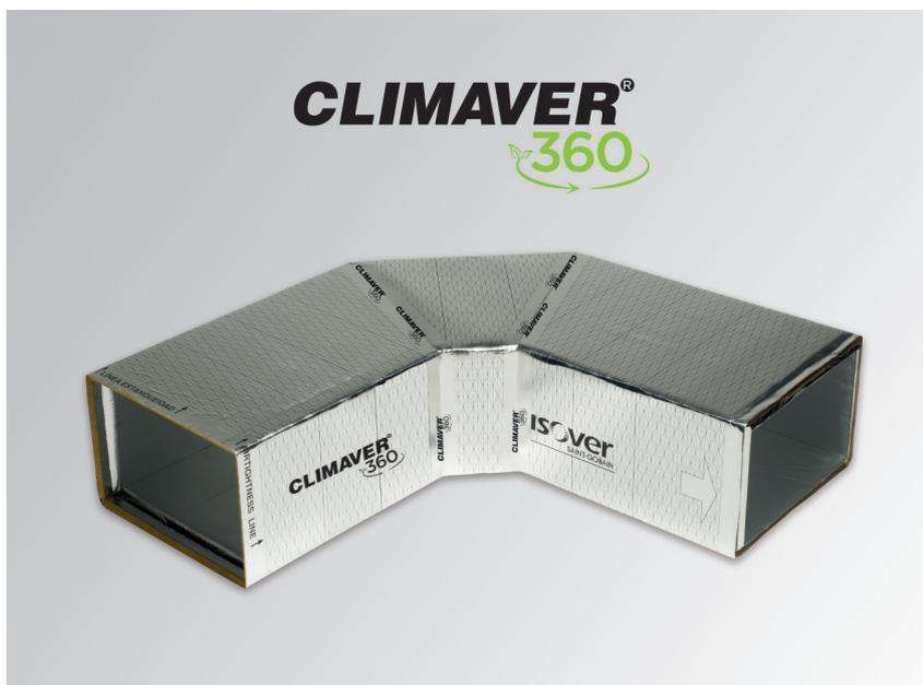
Panneau de laine de verre rigide **ISOVER** à haute densité, revêtu sur les deux faces d'une feuille d'aluminium mate renforcée par une maille de verre, qui fait office de pare-vapeur et offre une plus grande résistance mécanique. Le bord mâle est bordé par le complexe intérieur en aluminium mat. Il incorpore un voile de verre de chaque côté du panneau pour lui conférer une plus grande rigidité.
