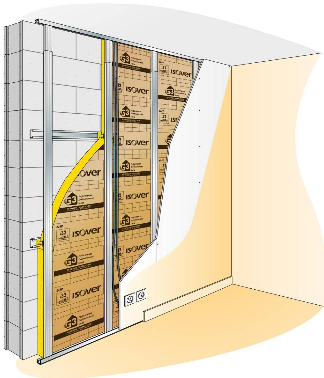
*Figure 12 : Pose du parement final*
